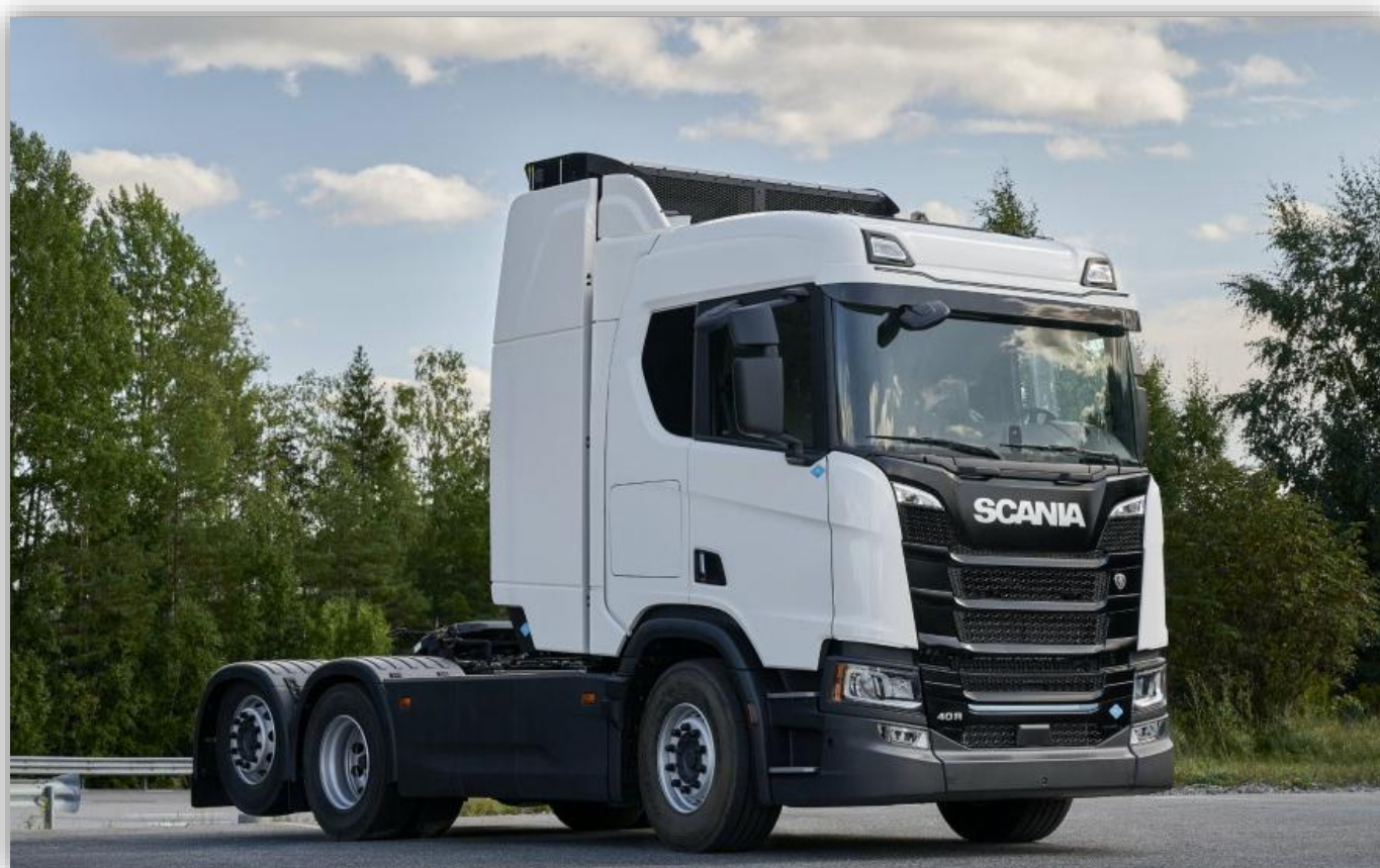
Scania lastbil med vätgasdrift
