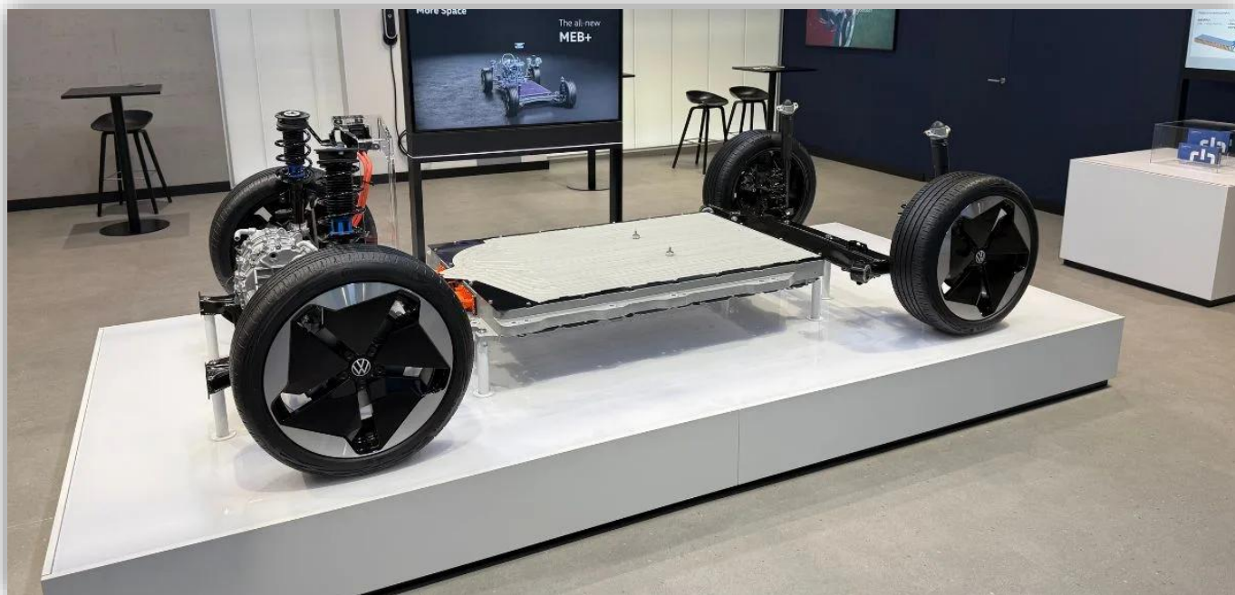
Den nya MEB+ som är framhjulsdreven till skillnad från tidigare MEB-bilar
