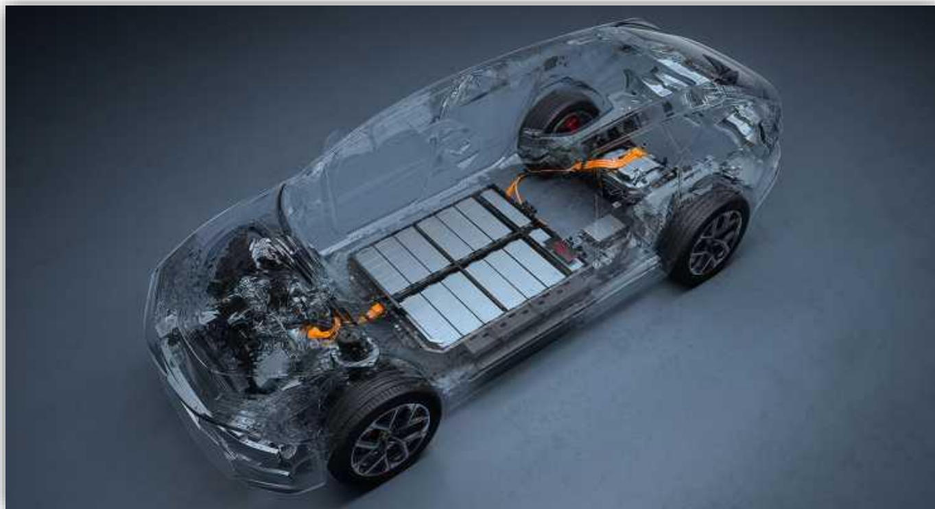
Ett enormt 70 kWh-batteri ger lång elräckvidd
