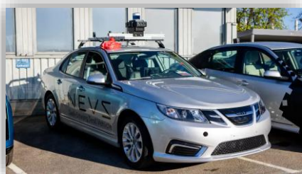
Nevs 9-3-prototyp för självkörning. Utrustad med GPS, lidar och kameror. Från 2018. Okänt miltal.
