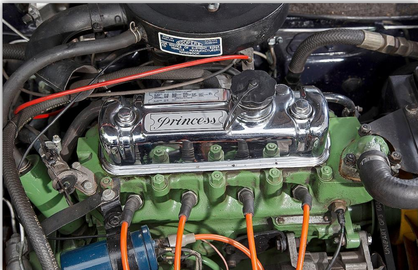
Den 53 hk starka Vanden Plas Princess 1300 drivs av BMC A-Series-motorn med störst slagvolym på 1275 kubikcentimeter.
