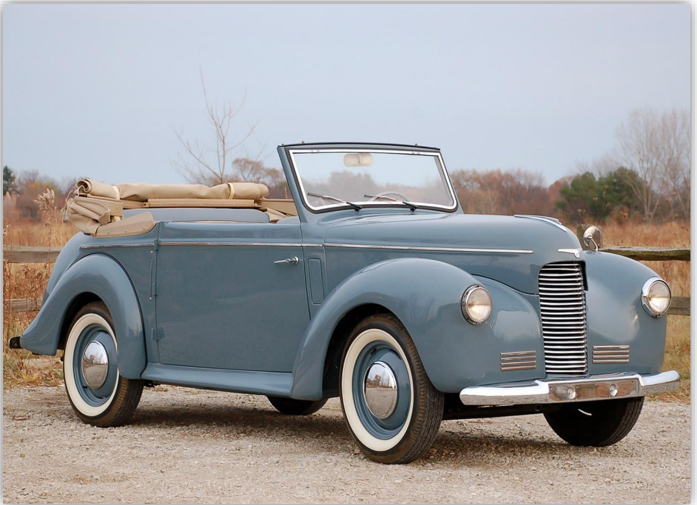
Förkrigsmodellen moderniserades 1947 med inbyggda strålkastare och rattväxel. De flesta var täckta men det fanns också en elegant Drophead Coupé.
