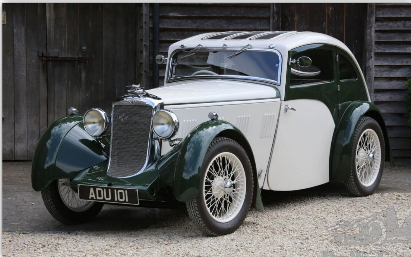
En sportbil var Aero-Minx med trimmad motor och splinesmonterade ekerhjul. Strömlinjeform var högsta mode 1933 men Aero-Minx fanns också i två öppna varianter i traditionell stil.
