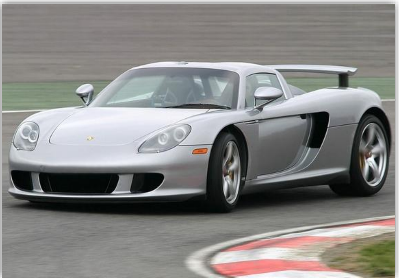
2004 kom Carrera GT. En superbil med en 5,7 liter stor mittplacerad V10 på 612 hk
