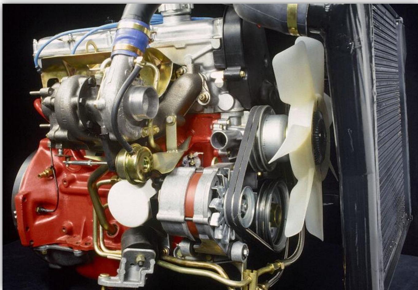
Volvo 740/760 med turbomatad B23ET-motor från 1983. Bilden visar avgassidan med turboaggregatet monterat.
