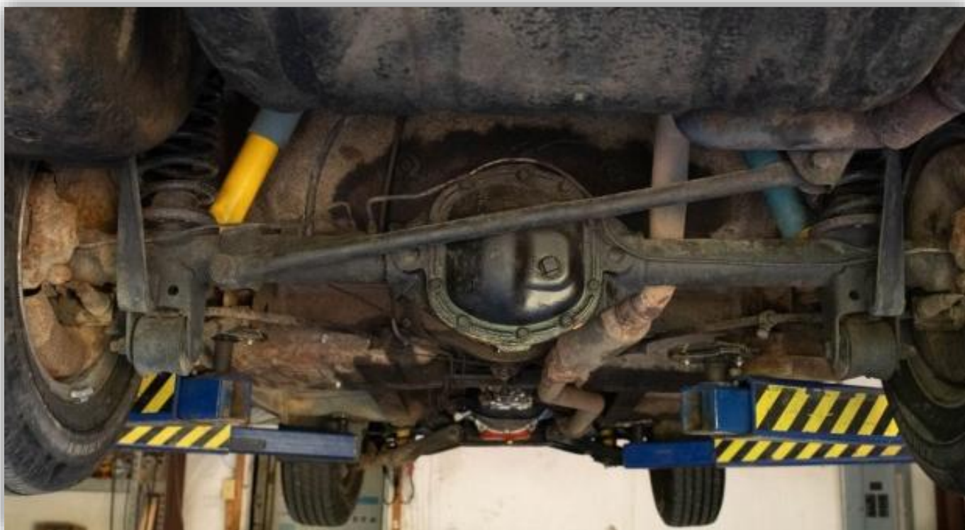
Kraften överförs till bakhjulen via en M41 fyrväxlad manuell växellåda med en Laycock de Normanville överväxel. Korrosion är synlig på undervagnskomponenter.
