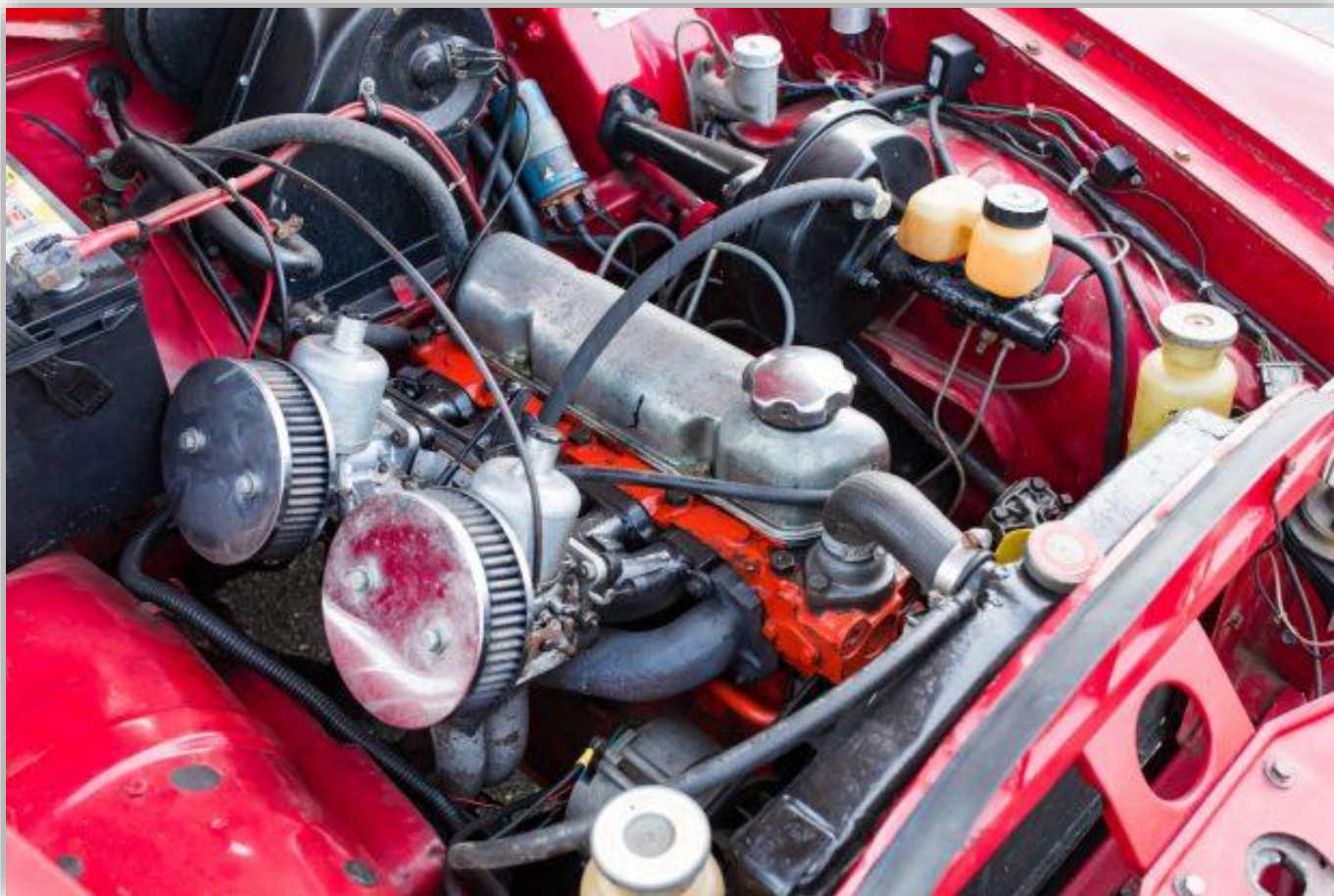
Den 1,8-liters B18B raka fyran är utrustad med dubbla SU-förgasare och var fabriksklassad till 115 hästkrafter.
