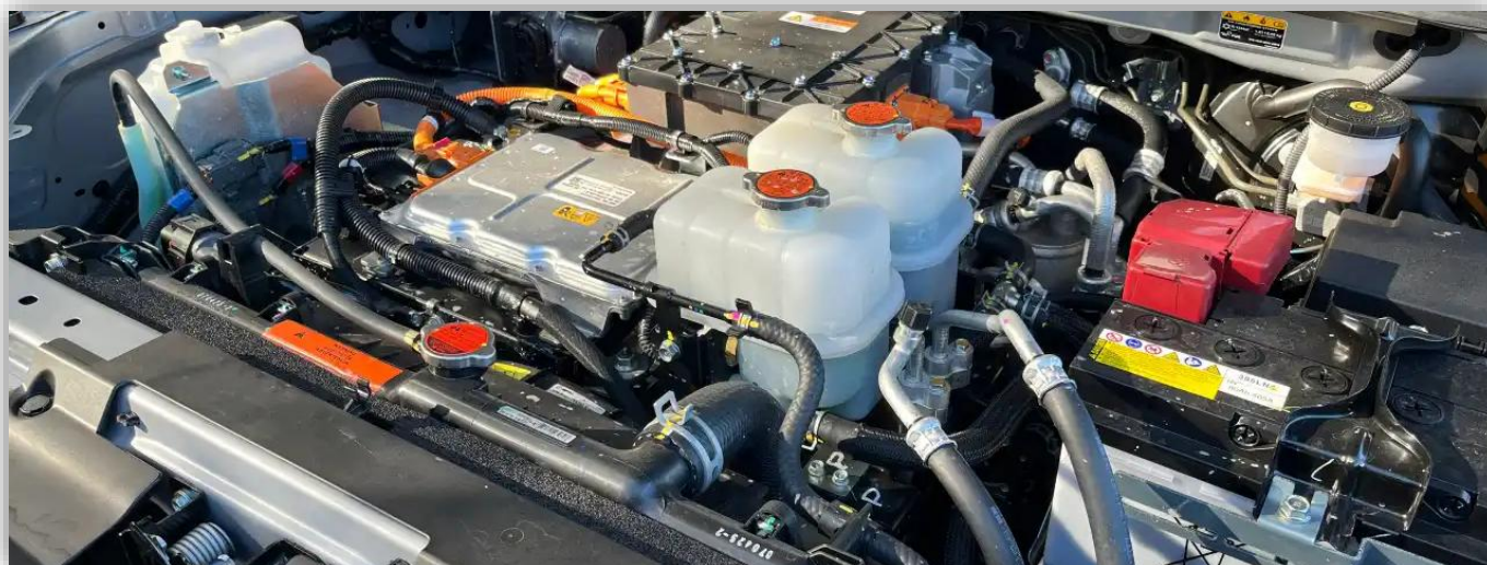
Dieselrovan fram är urluft och ersatt med en egenutvecklad elmotor
