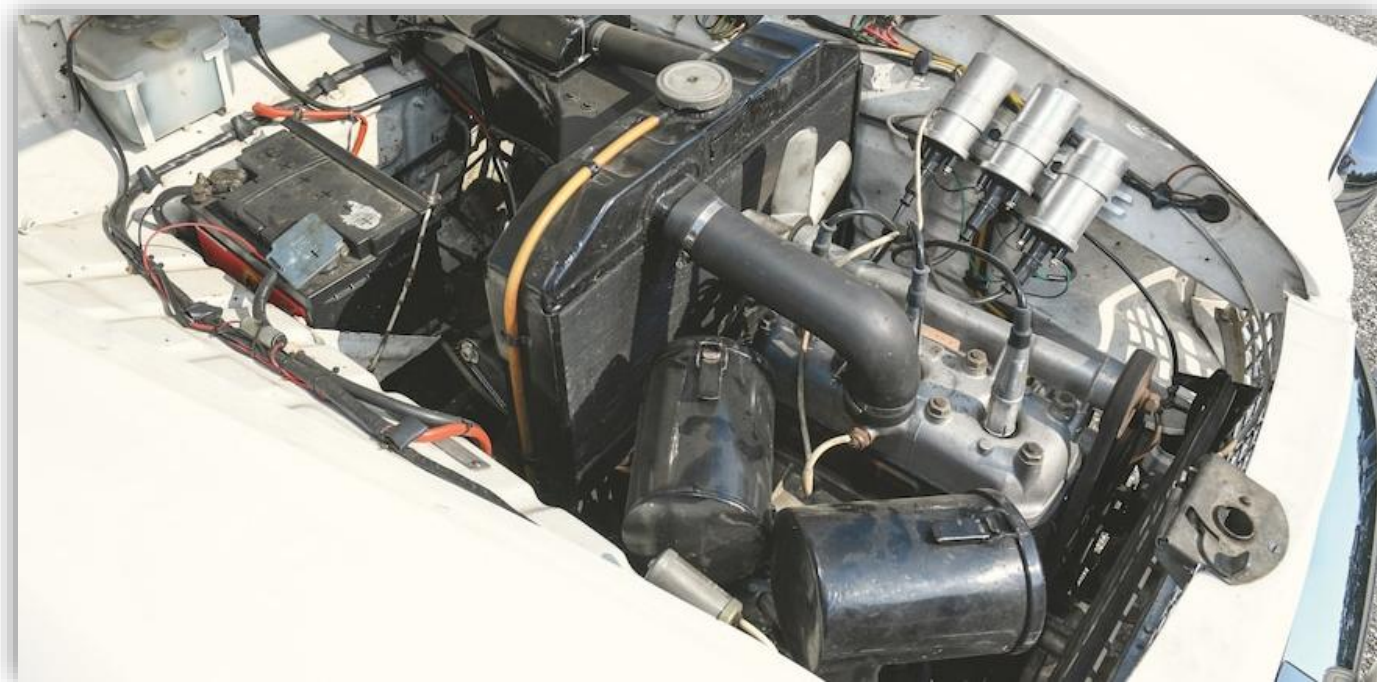
De två BVF H 362-förgasarna med sportluftfilter, till höger i färdriktningen, trumpetar infernalt.
