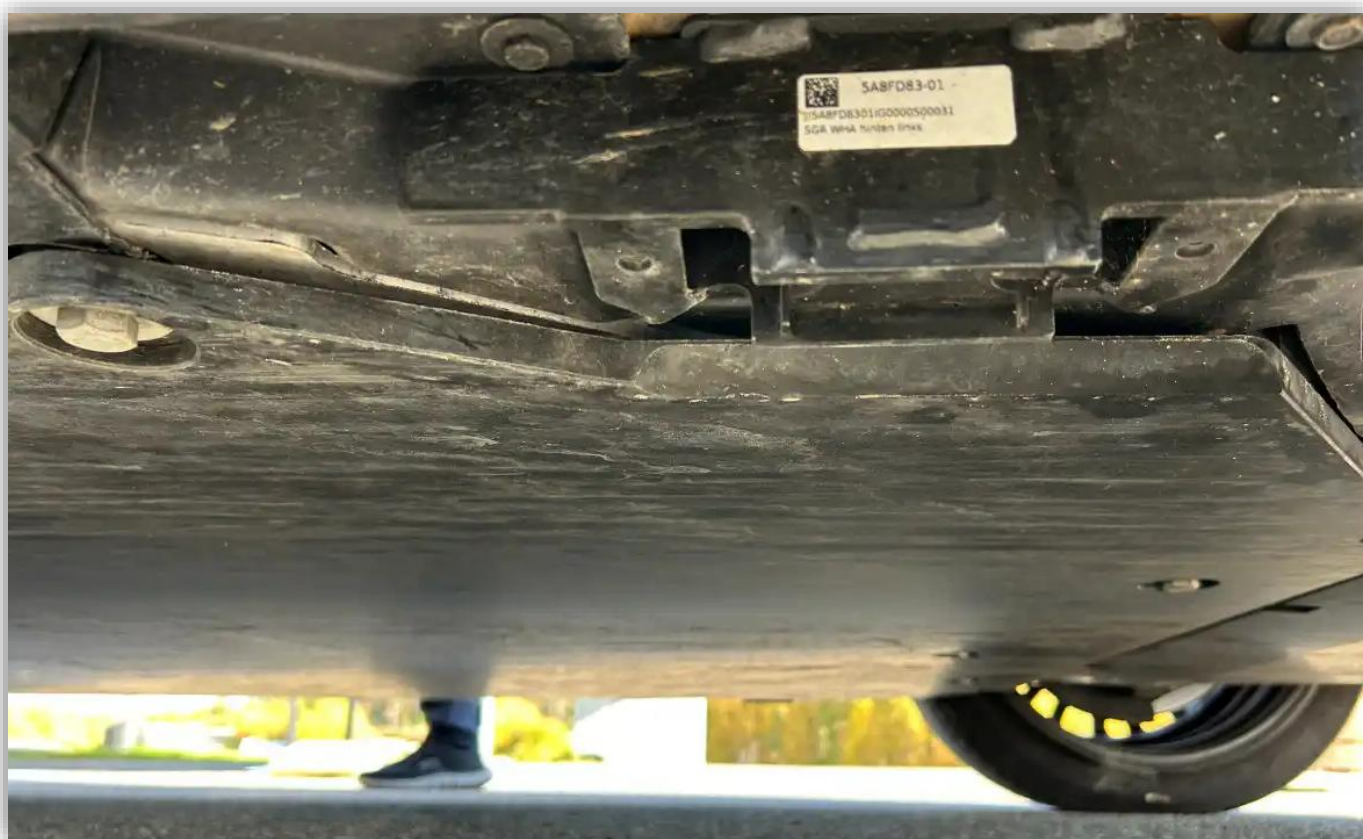
Bottenplattan är förstärkt med pansarstål
