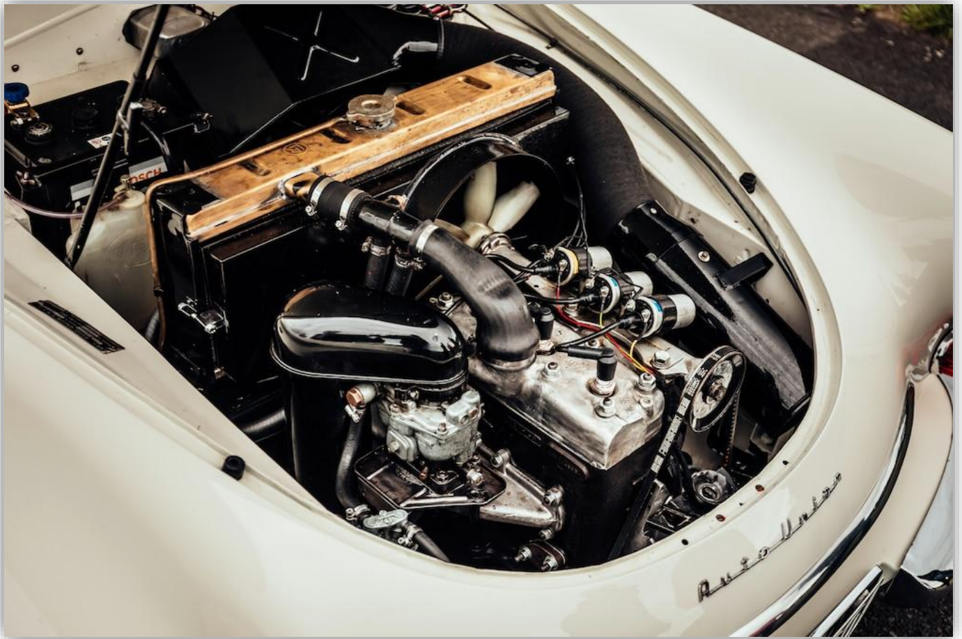
Motorn i Auto Union 1000 Sp är monterad långt fram; trots detta vilar endast 55 procent av vikten på framaxeln.
