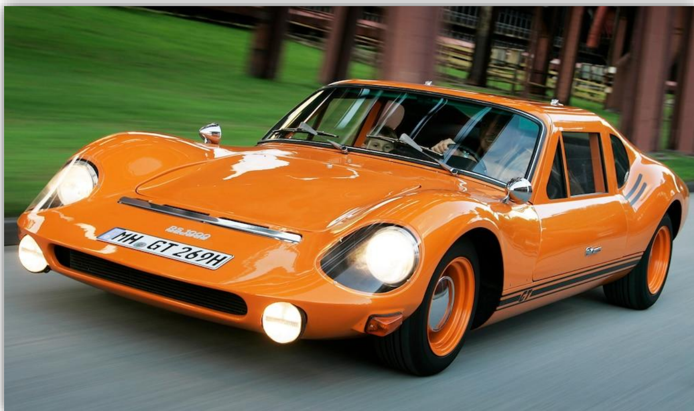
Strålkastarskyddet, unika i DDR, är tillverkade av Piacryl från VEB Stickstoffwerk Piesteritz. Formen skapades efter en design av Weißensee Konstakademi, och den skulle troligen ha klarat sig med vanliga dörrar.
