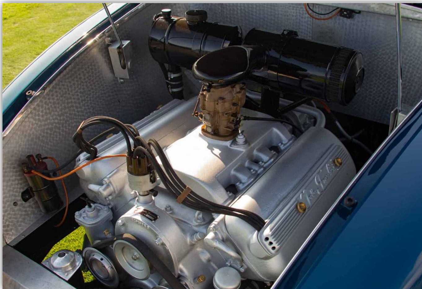
Den kompakta V8-motorn var monterad bakom bakaxeln
