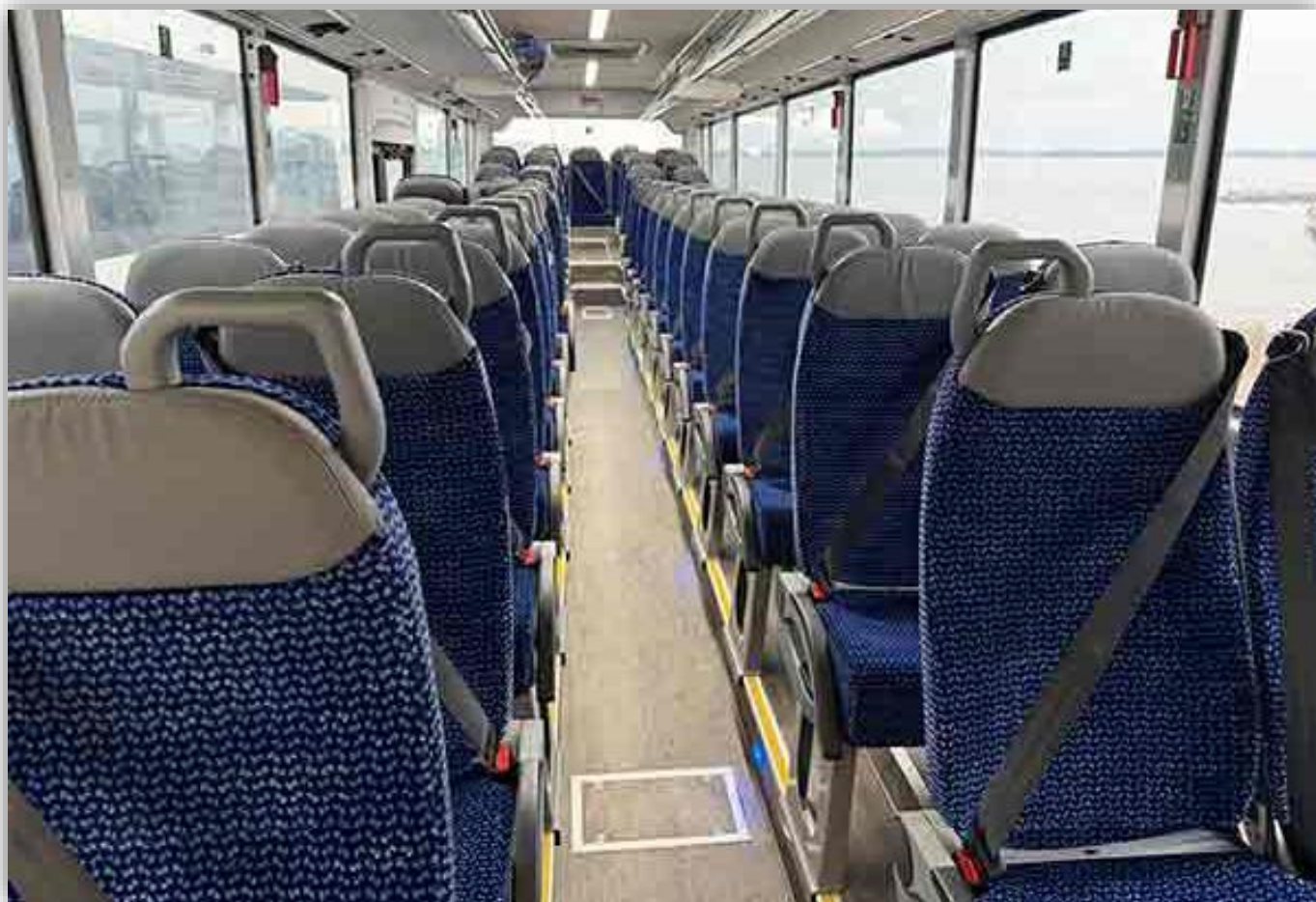
De tre bussarna är klass II-bussar med normalgolv och 680 mm stolsavstånd samt fasta stolsryggar.
