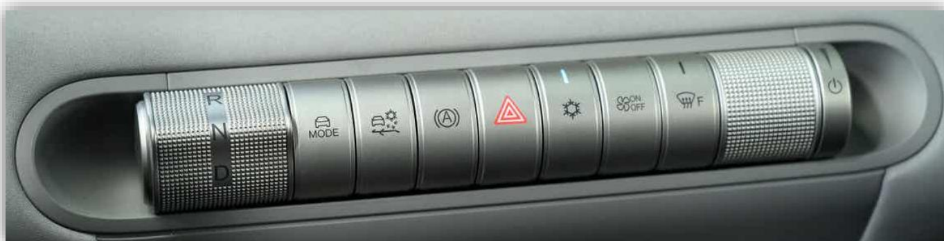
Manöverpanelen under pekskärmen har små och otydliga symboler Längst till vänster finns växelvredet
