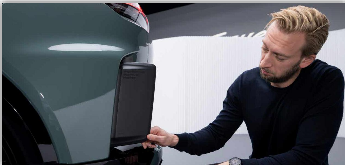
De utfällbara vingarna i bakre stötfångaren minskar luftmotståndet på Turbo-modellen
