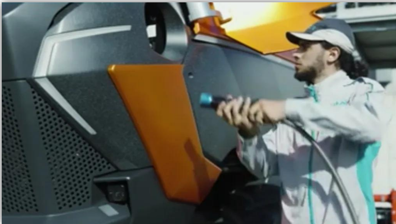
Vätgasen lagras i tankar, där den omvandlas till elektricitet via bränsleceller.
