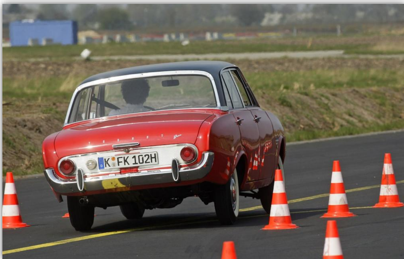
Den bladfjädrade stela axeln ger liten komfort och bromsarna behöver mycket utrymme.
