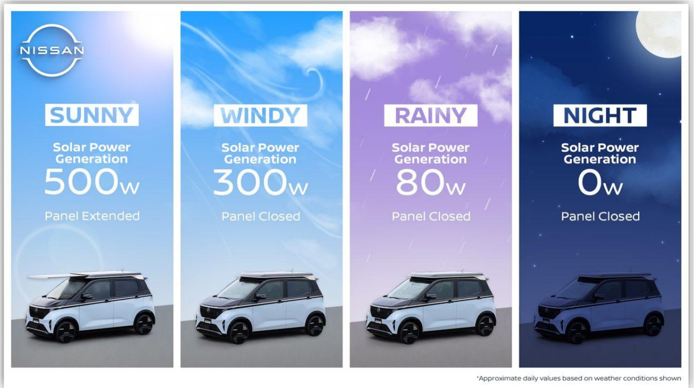
En illustration som Nissan tagit fram visar hur mycket ström panelen kan producera under olika väderförhållanden. Utfälld och under soliga dagar kan den ge 500 W.
