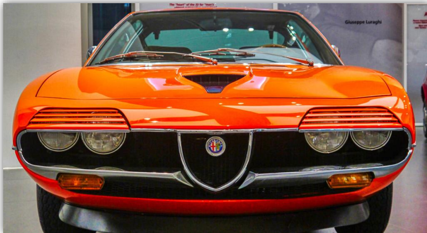
Strålkastarlocken som fälls upp över dubbla lyktor. Alfa Romeo Montreal har många designdetaljer som sticker ut.
