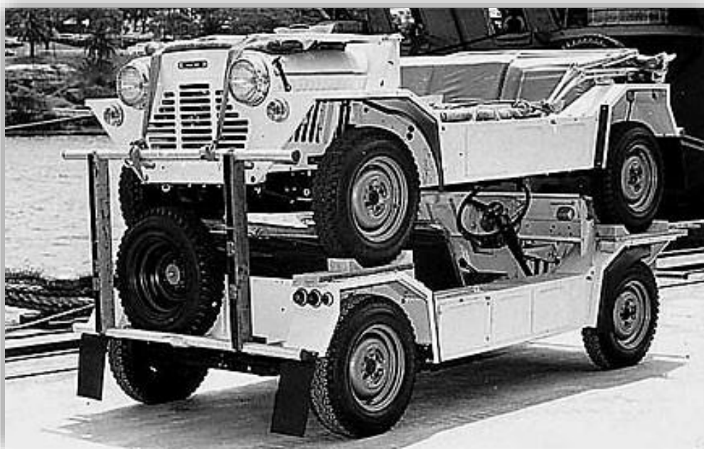
Karossen utformades så att bilarna skulle gå att stapla på varandra.
