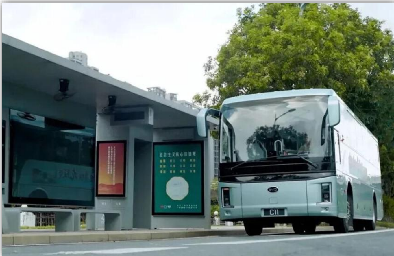
Bussen C11 som med batterier på upp till 593 kWh ska klara 400 km körning med full last och klimatanläggning påslagen. BYD
