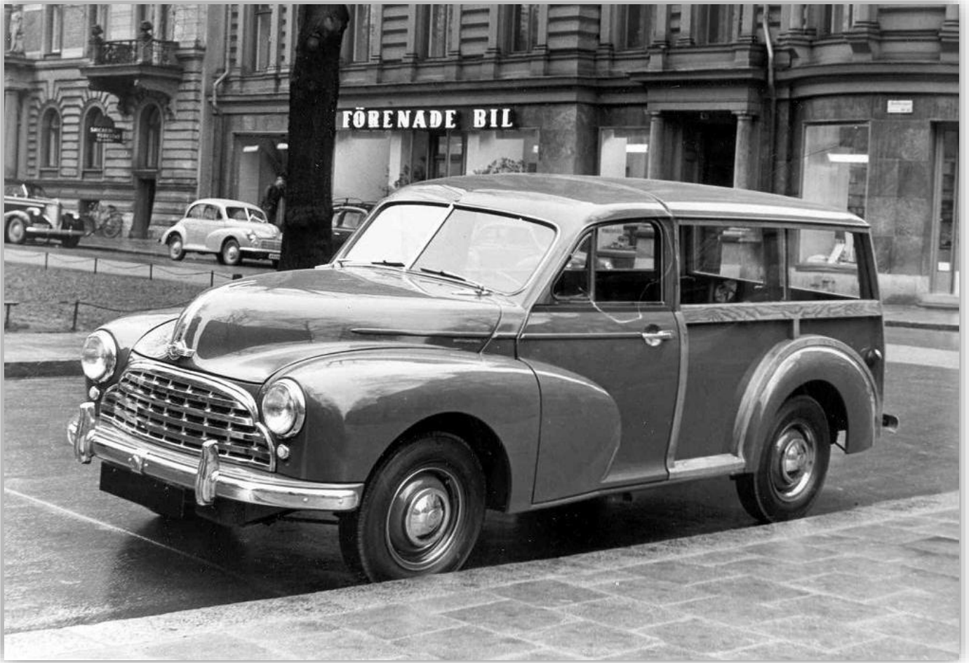
Oxford MO fanns från hösten 1952 också som kombi med bärande karosstruktur i askträ.
