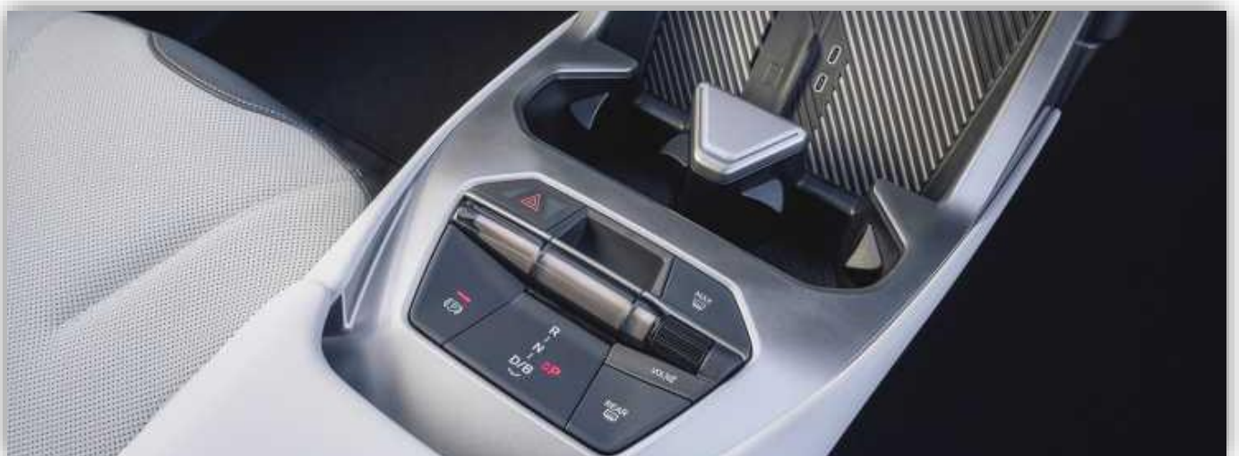
Fysiska reglage för varningsblinkers, parkeringsbroms, växelväljare, defroster och volym, resten får man lov att styra via rattknappar, pekskärm och röstkommandon.
