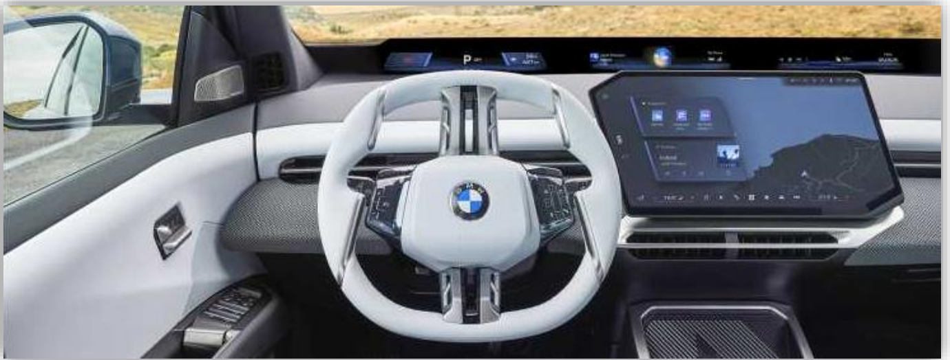
Ratten har speciell form med ekrar "klockan tolv" och "klockan sex". Framme vid vindrutan visas hastigheten.
