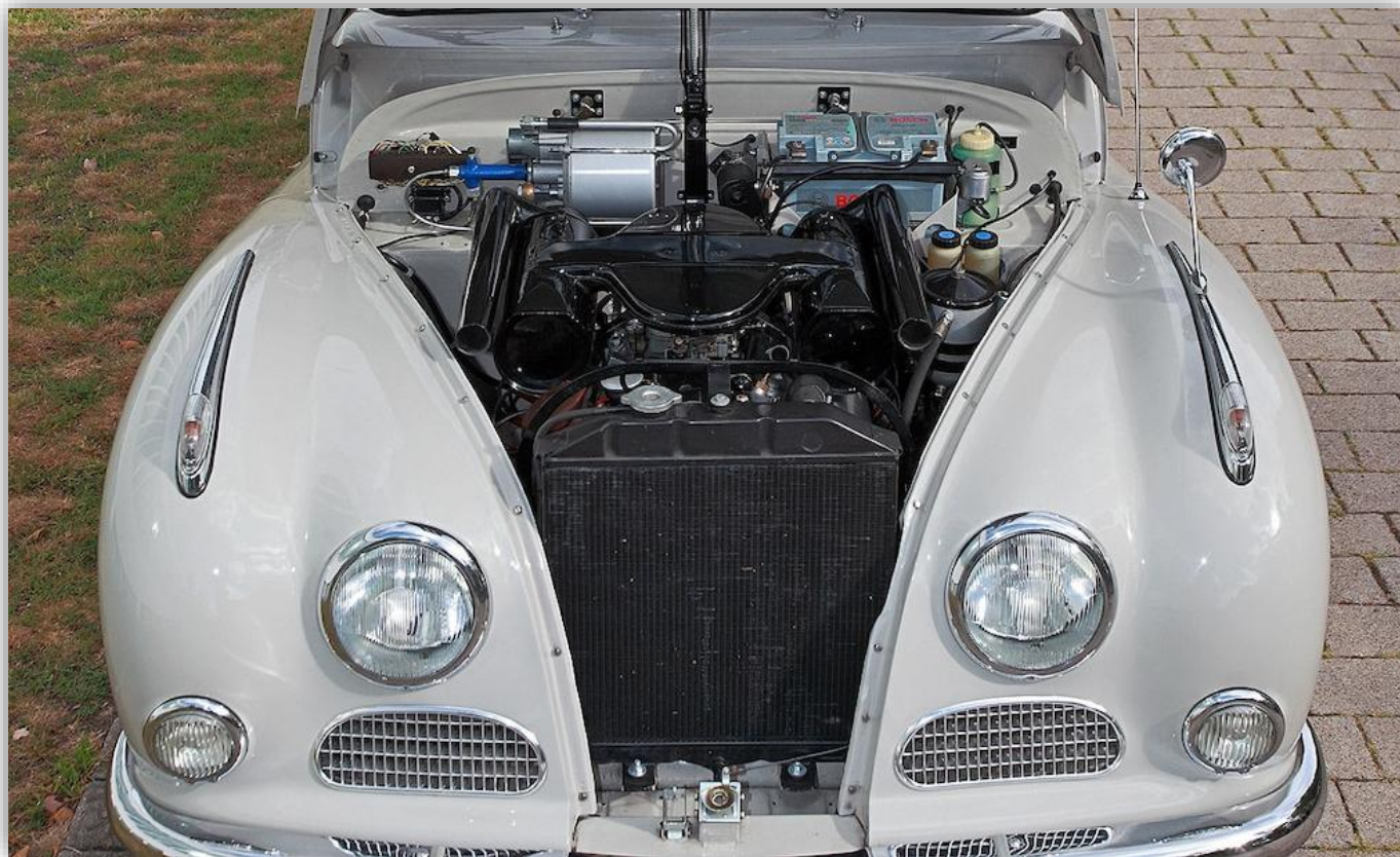
3,2-litersmotorn kröns av två förgasare som andas in genom ett gigantiskt luftfilterhus. I bakgrunden till vänster: Hydrovac bromshjälp.
