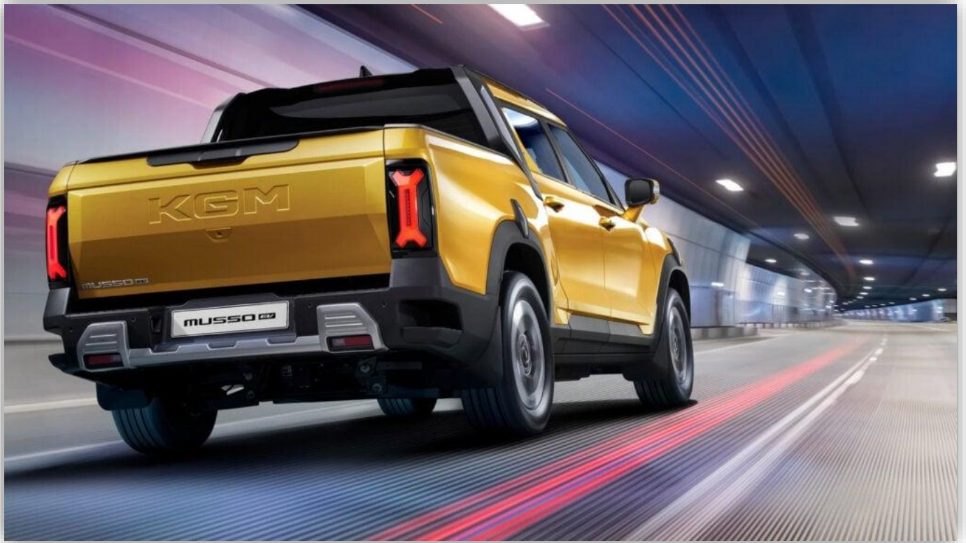
KGM Musso EV 4x4 får lasta 780 kg och dra 1,8 ton. Foto: KGM
