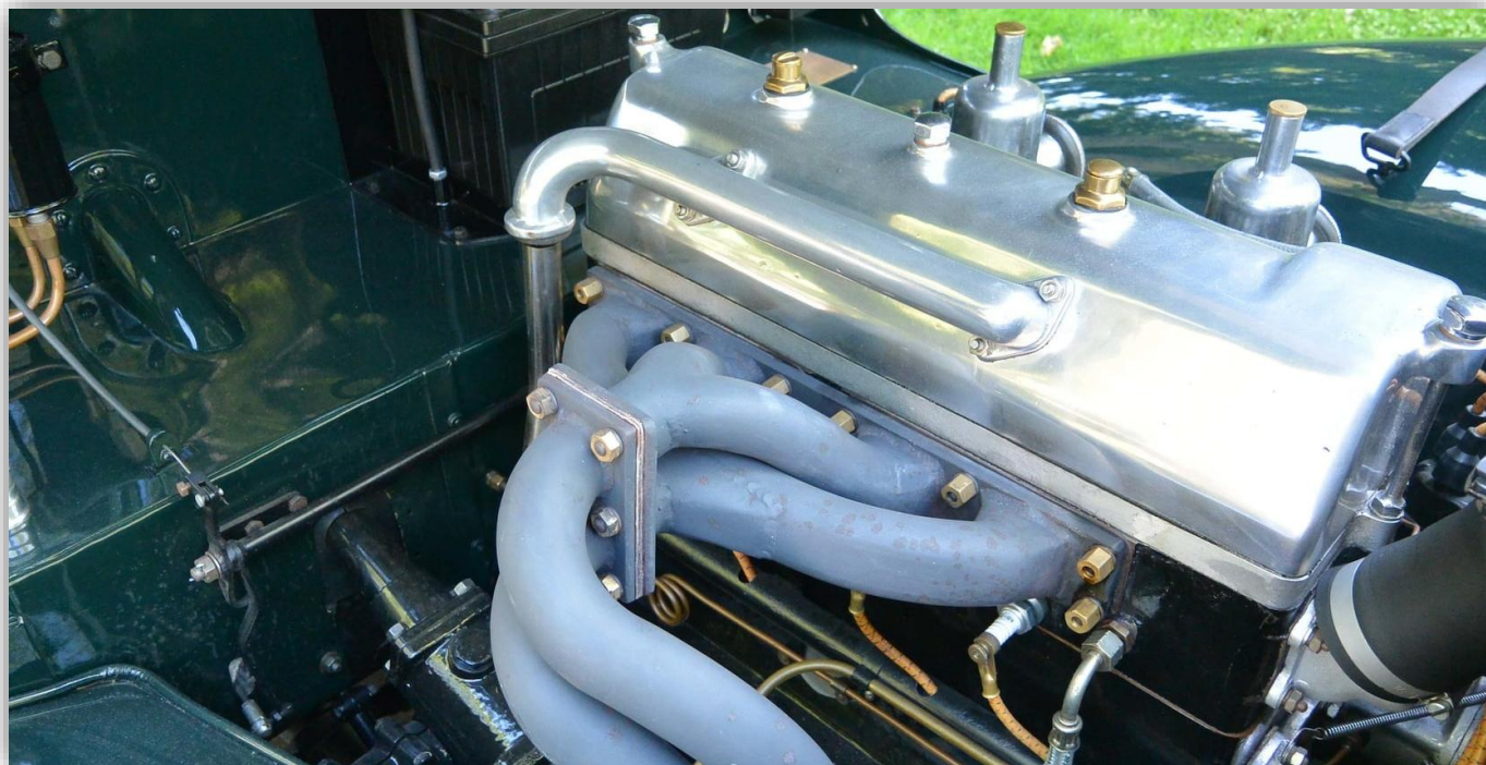
Claude Hill konstruerade en 2,0 liters OHC fyrcylindrig motor.
