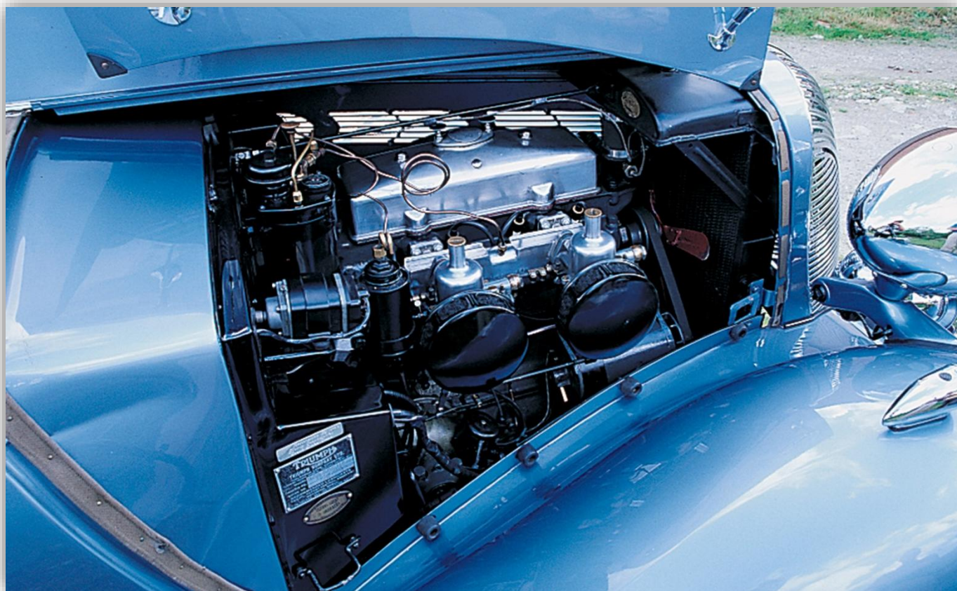
Denna Triumph Dolomite Roadster Coupés SU-förgasare har för närvarande TR2-pannkaksfilter
