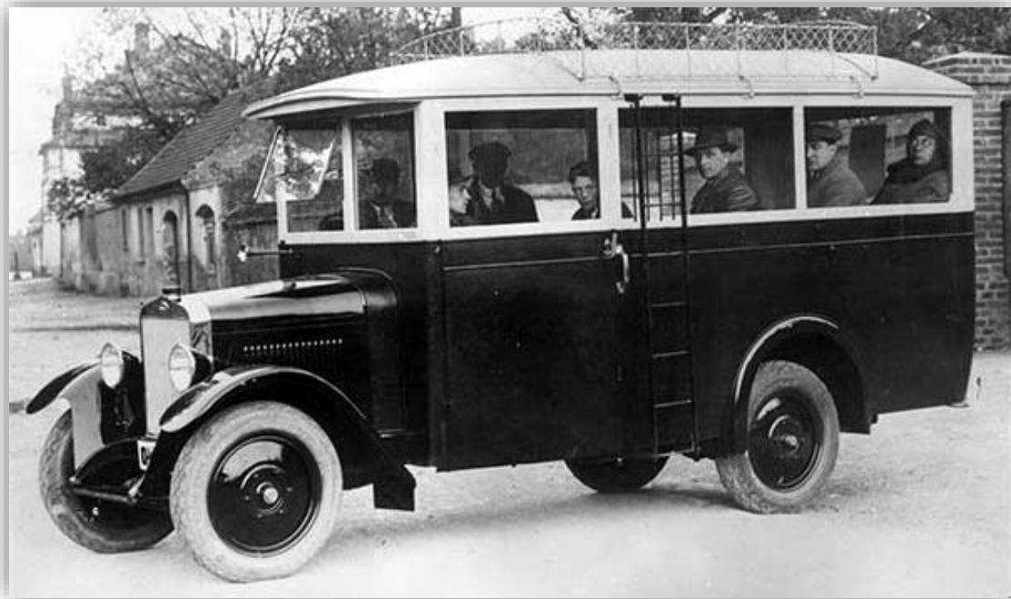
1928 rullade den första bussen ut från fabriken, byggd på chassi från Skoda och med plats för fjorton passagerare.
