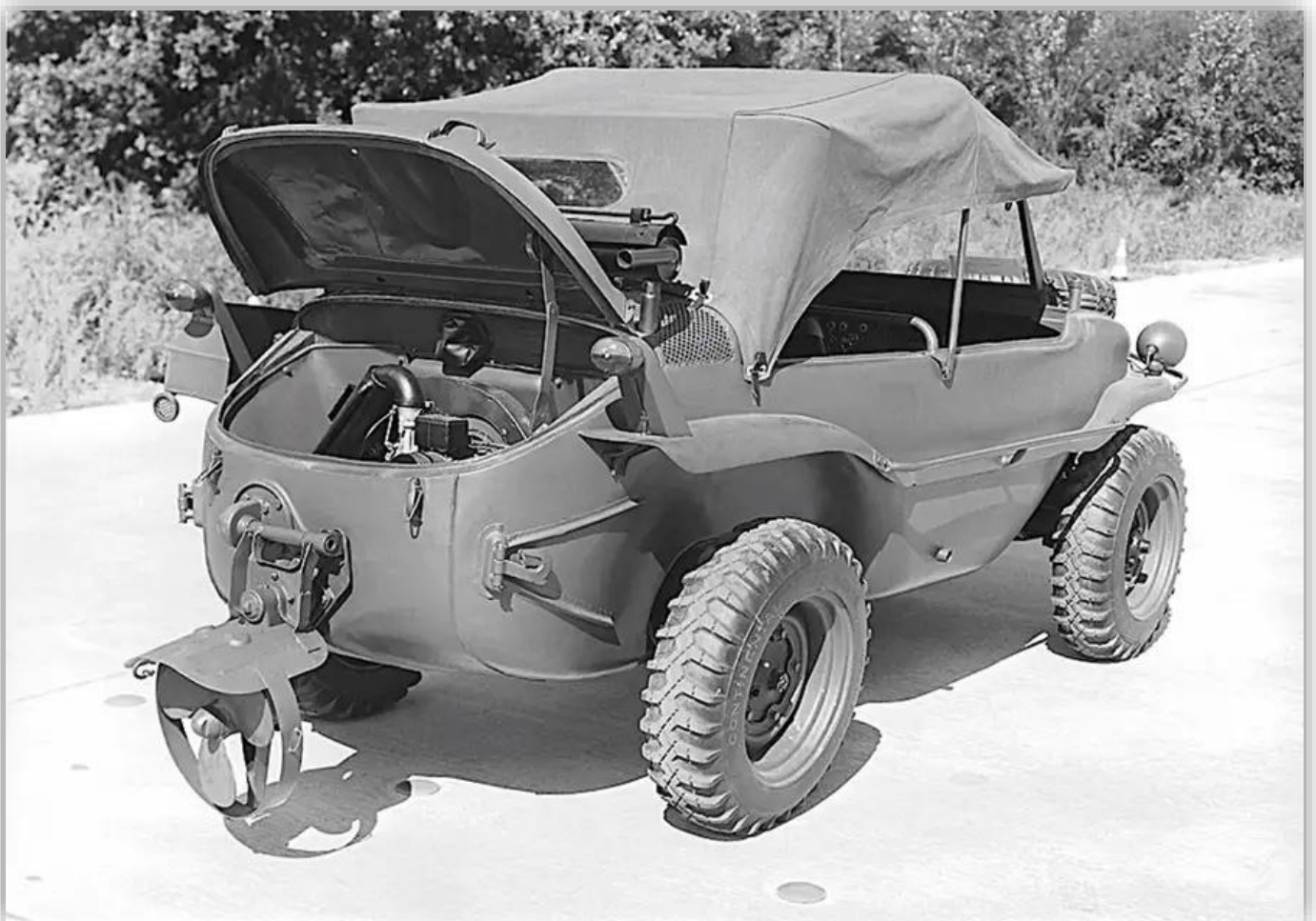
Amfibiebilen Volkswagen Typ 166 Schwimmwagen var i stort sett en Folkvagn med hög markfrigång och nedfällbar propeller.
