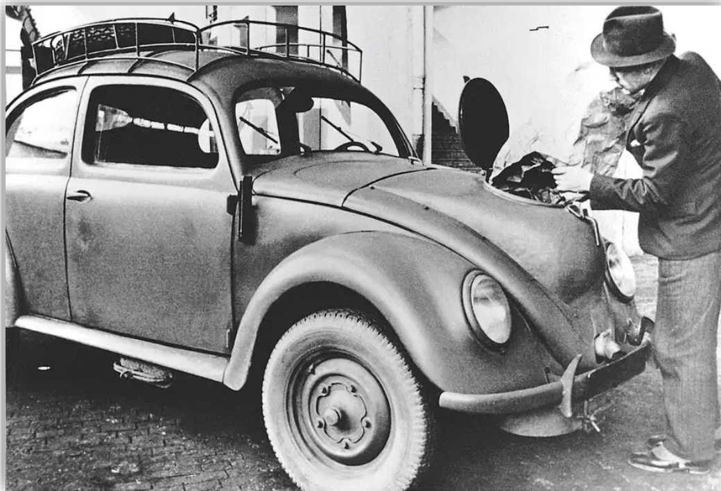
Även en Folkvagn tvingades i brist på bensin köras på gengas. Den lilla puckeln på bagageluckan var relativt diskret.
