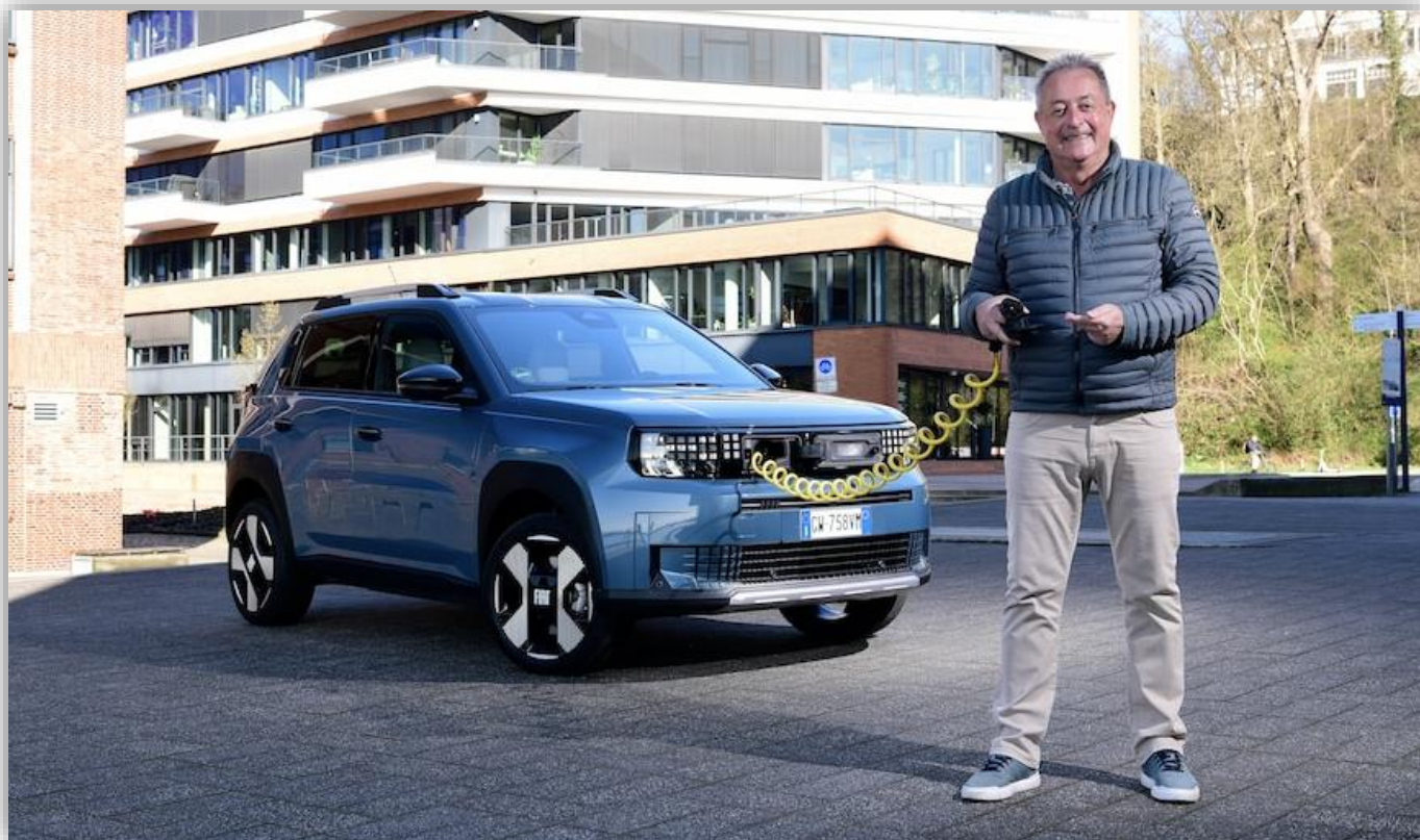
Smart: FIAT Grande Panda revolutionerar laddningen med en infällbar kabel som stuvats in under motorhuven för att spara utrymme och som sträcker sig från frontgrillen
