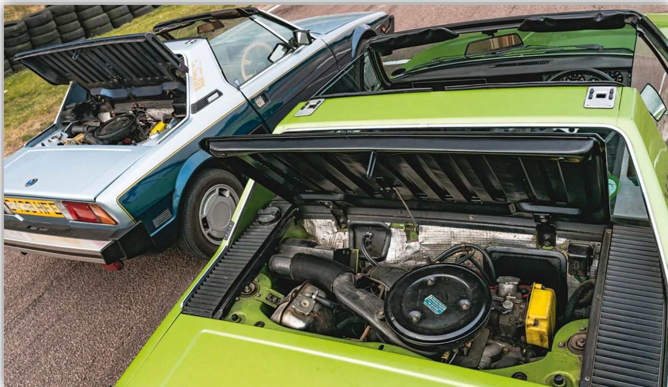
Motorn på 1498 cc som var monterad på 1500 (vänster) ökade effekten till 85 hk jämfört med 1300:ans 73 hk
