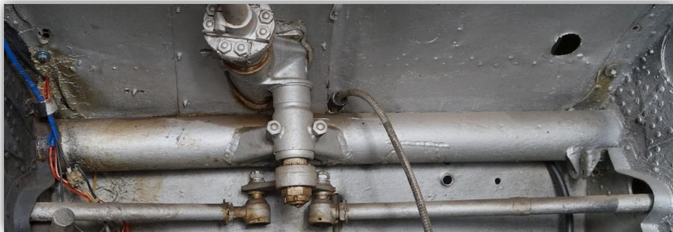
Styrlänkaget är inkapslat i dammtäta rör som är ordentligt anslutna till karossen. Den styr fjäderbenen i toppen.
