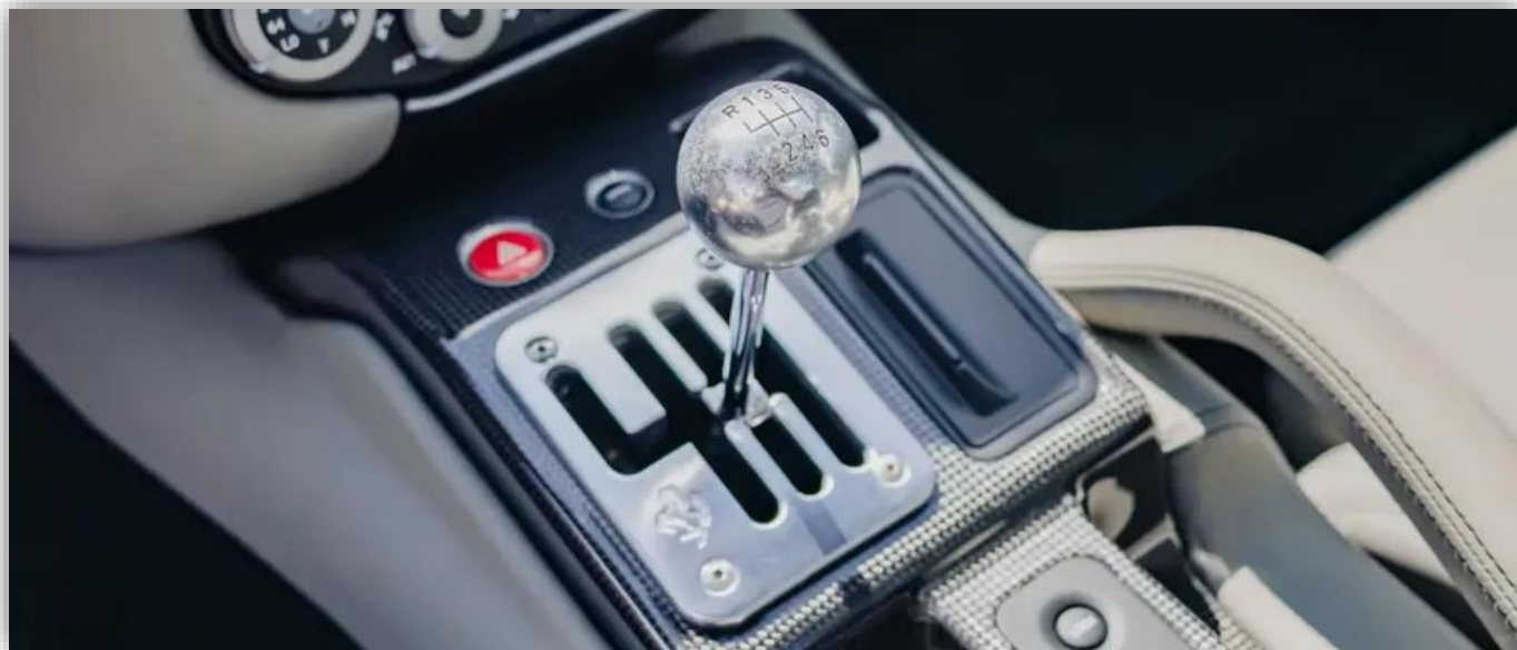
En manuell växellåda på en 2007 Ferrari 599 GTB Fiorano.
