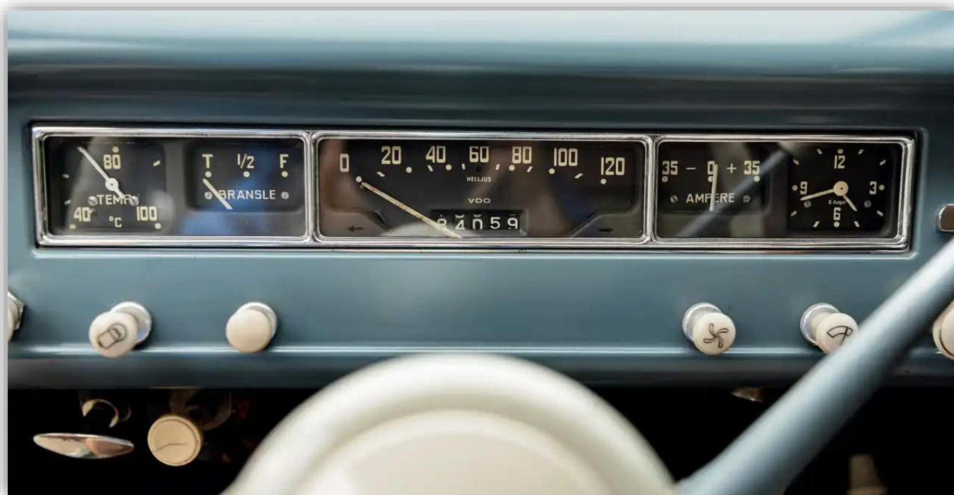
Snygga rektangulära instrument som från vänster visar motortemperatur, bränslemängd, hastighet, laddning och tiden som går. Snart har det gått 60 år.
