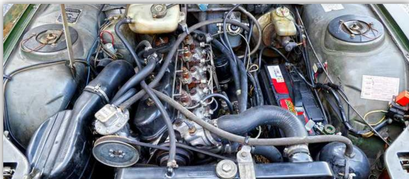
Den 2,1 liter stora dieseln med virvelkammare och insprutningspump från Bosch/Roto gav 65 hk.
