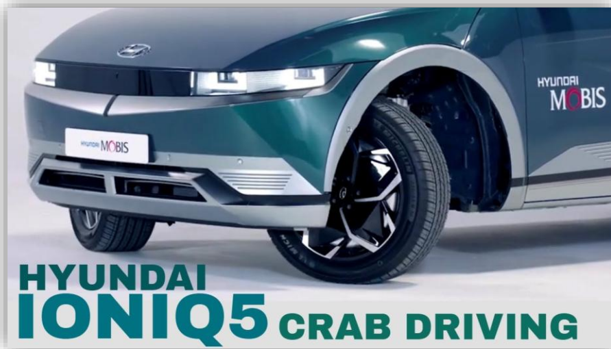
Krabbgång med Hyundai Ioniq 5 Alla fyra hjulen går att vrida 90 grader
