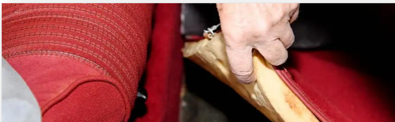
Undersidan av mattorna är gediget isolerade, i Pallas-versionen med ett extra tjockt lager skumgummi, för att kupén ska bli tyst (och golven rostiga).
