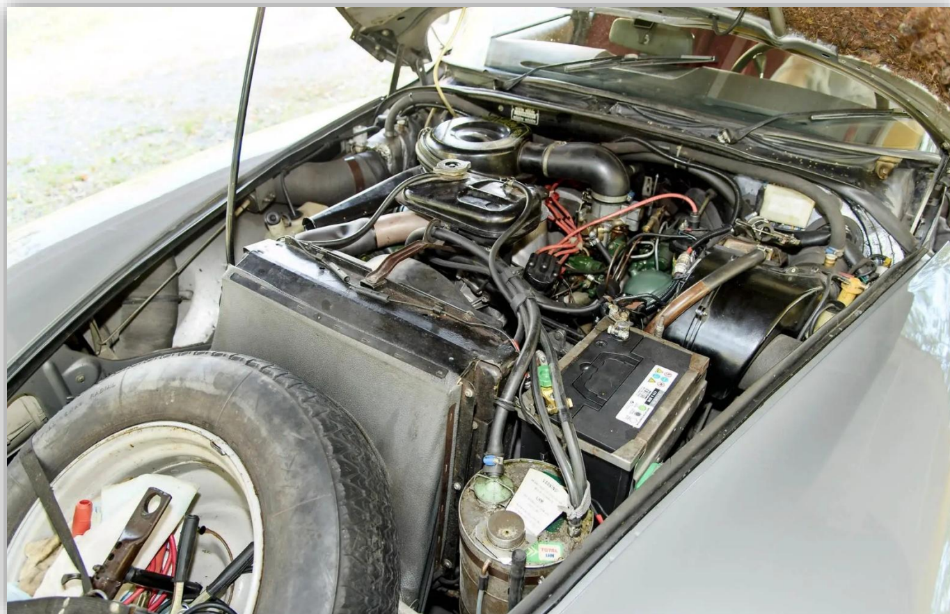
En av bilvärldens längsta motorhuvardöljer ett hav av hydraulikslangar och en gammal stötstångsfyra med rötter i 1930-talet. Stora DS 23-motorn kom 1972.
