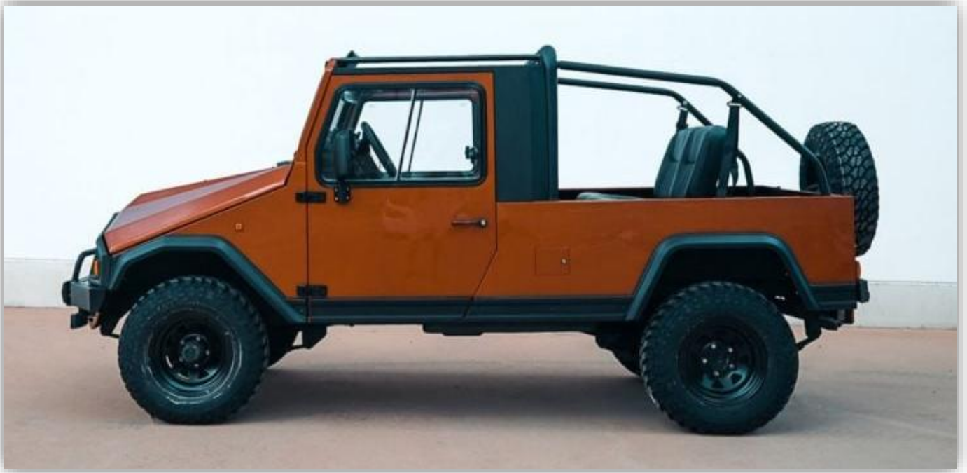
Alter II:s brant sluttande nos var utformad för att säkerställa att förarna skulle ha utmärkt sikt över framskjuten terräng
