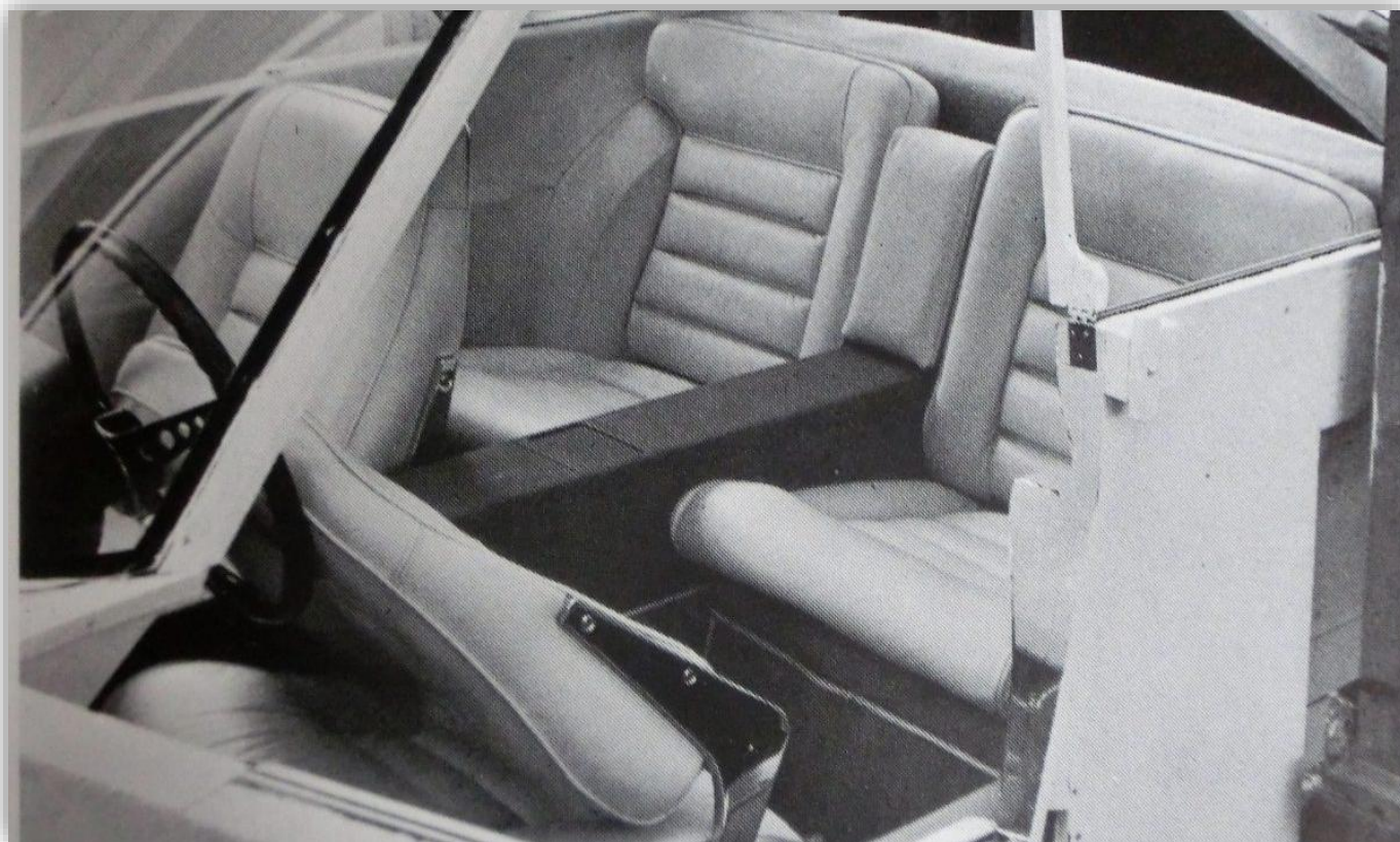
Attrappen av inredningen. Visar tydligt att Volvo tänkt sig endast två + två bilen. Kardan-tunneln är placerad så att det omöjliggör en tredje person i baksätet.
