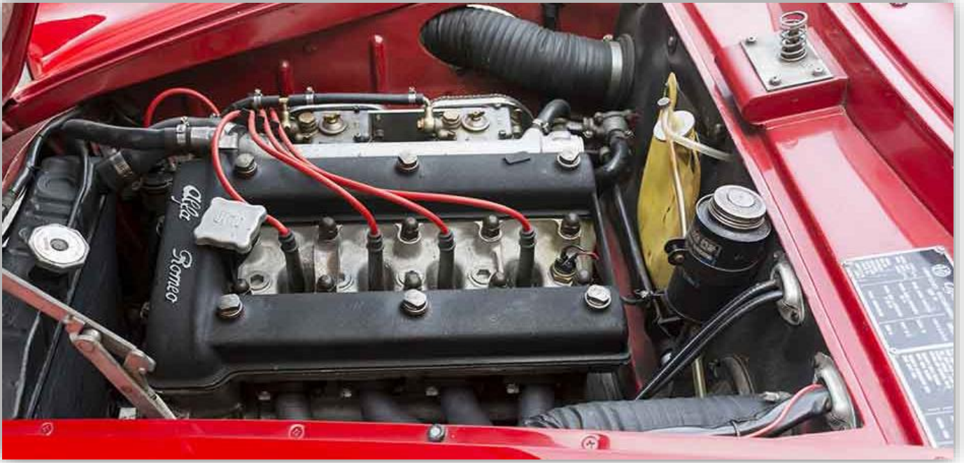
Alfa Romeo Twin Cam rak fyra 1290 cc motor.
