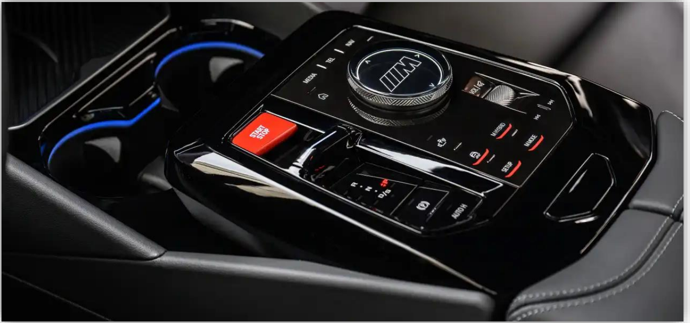
Den lilla växelväljaren på mittkonsolen kommunicerar med en åttastegad låda.
