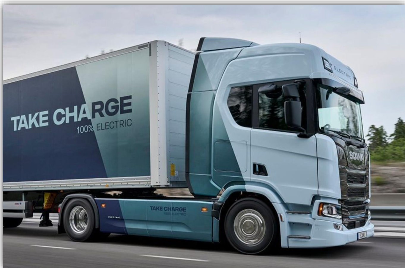
Scania 40 R som tvåaxlad dragbil. På IAA visas den med en motor på 400 kW.
