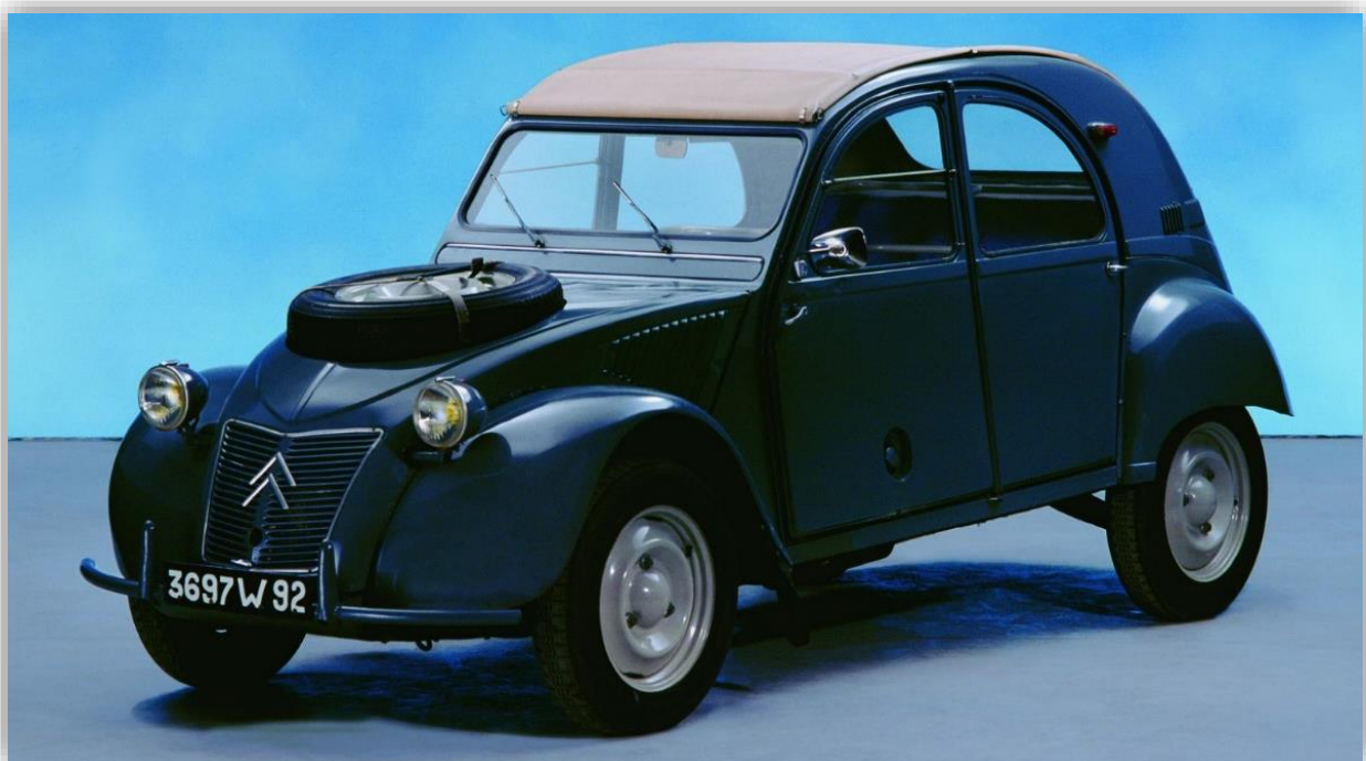
2CV 4x4 Sahara 1960–71 (med dubbla motorer, en fram och en bak).
