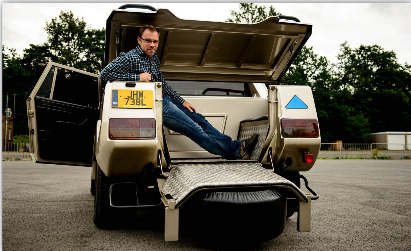
Flaklock och reservhjul på bakpanelen. Se bara till att ha friska gasdämpare, annars blir det tungt.
