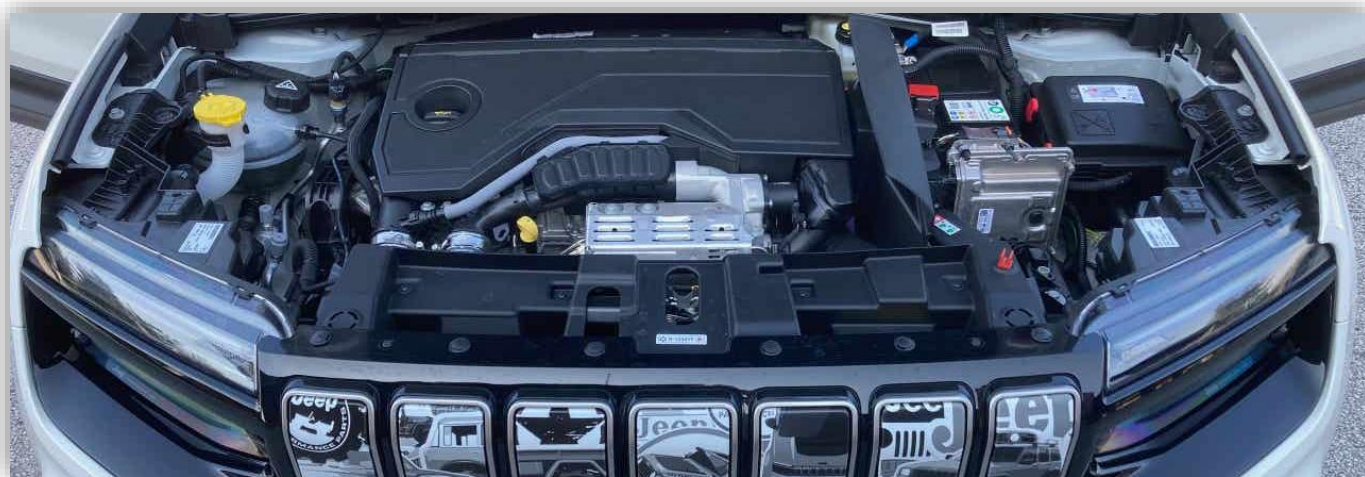
Liten trecylindrig bensinare på 100 hästkrafter får hjälp av en elmotor.
