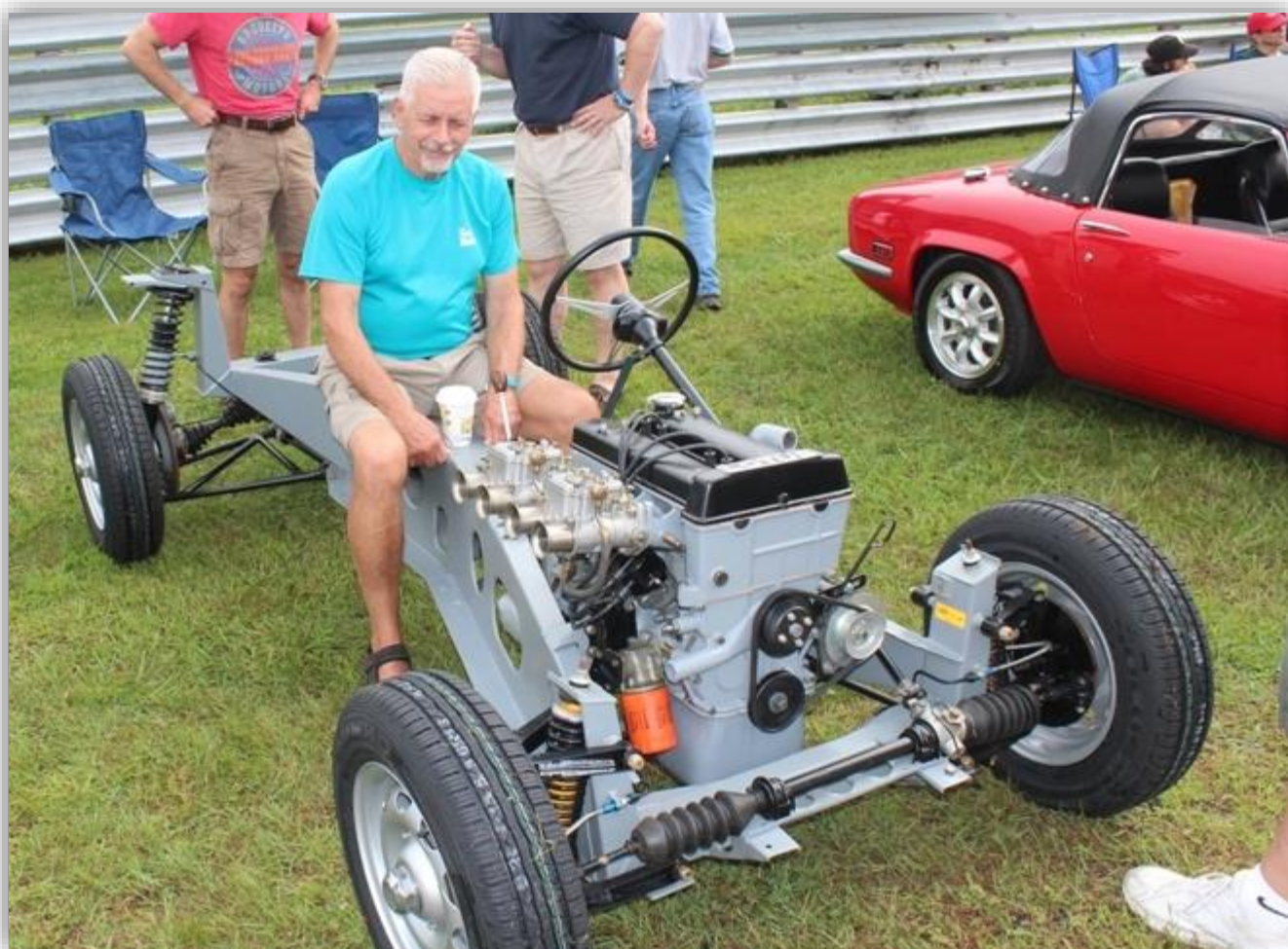
Lotus Elans ryggradschassi tillverkades i form av ett "X" med motor och växellåda fram och differential med individuell bakhjulsupphängning bak.
