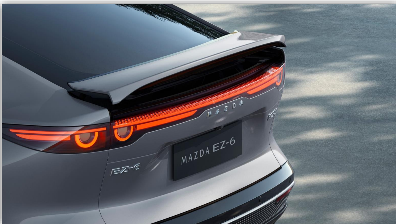
En uppfällbar vinge på bakluckan sägs öka högfartsstabiliteten.
