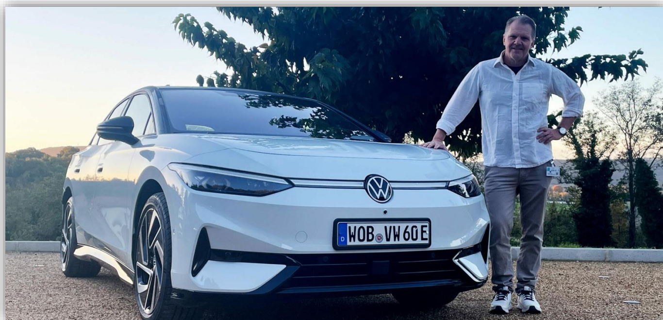
Ett cW-värde på 0,23 bidrar till lång räckvidd: 618 km.
