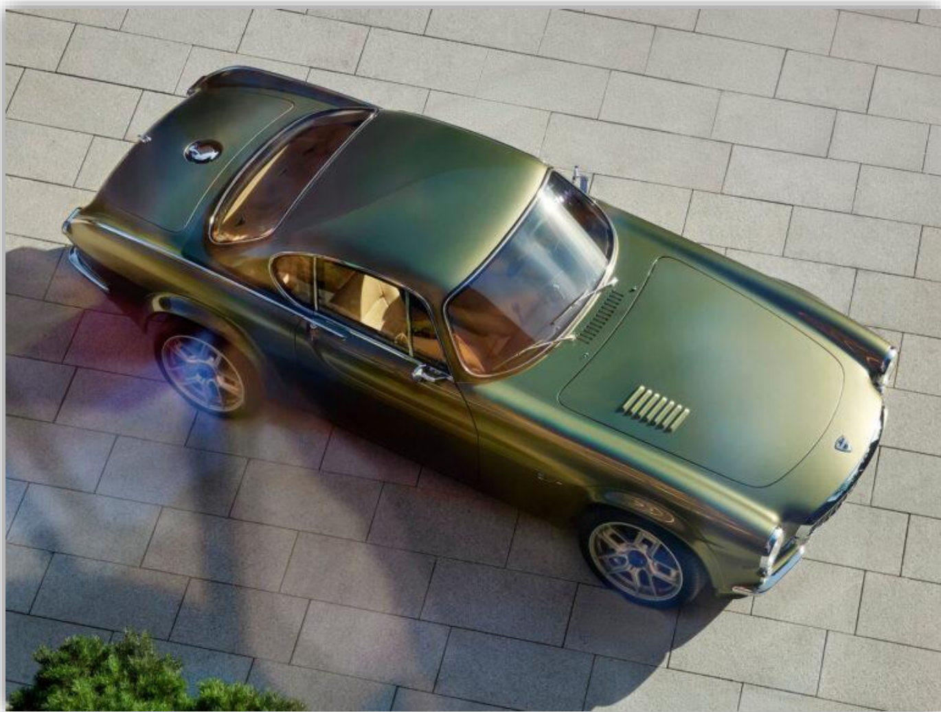
Karossen är byggd i stål och kolfiber.
