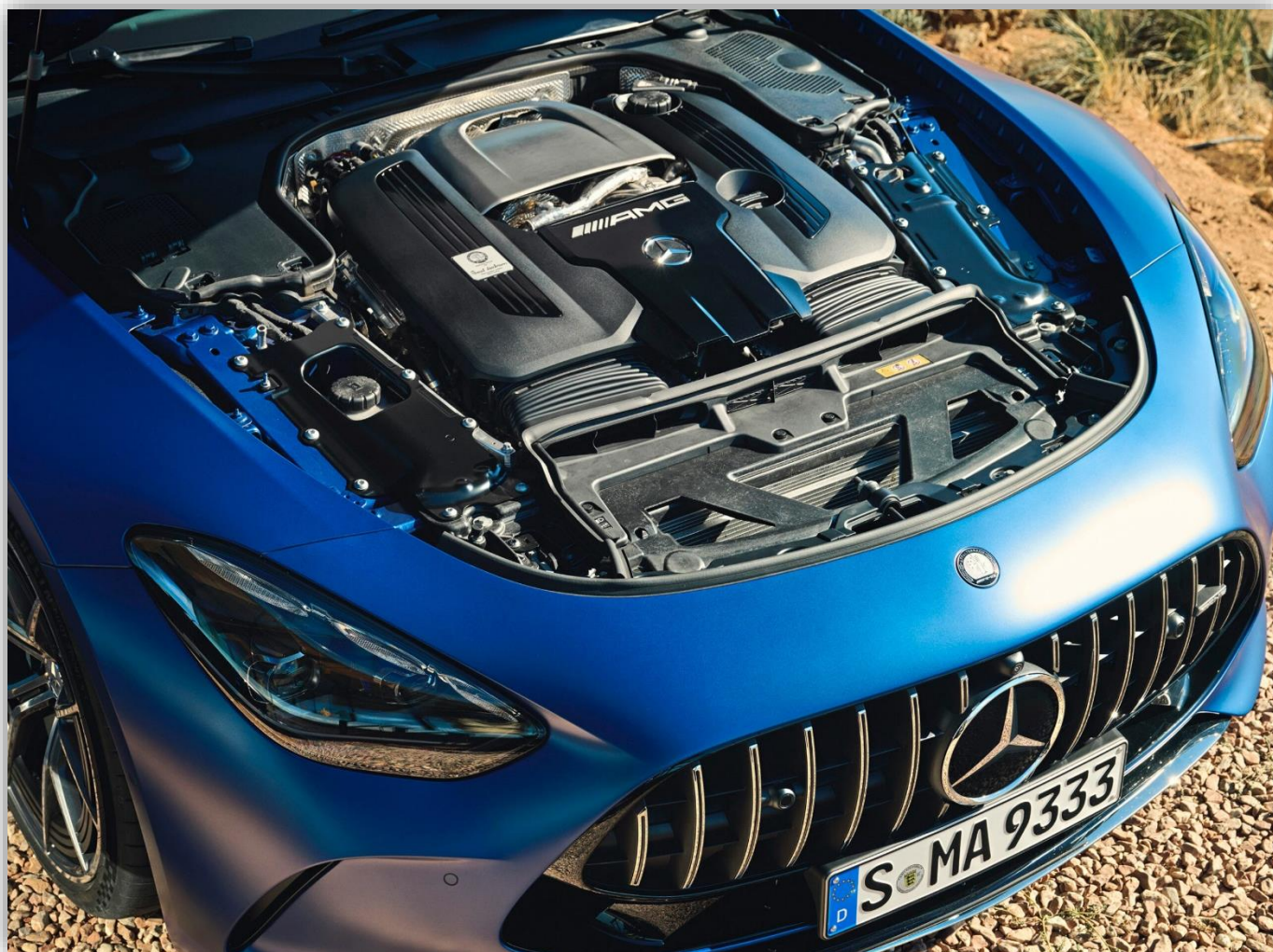
AMG-V8:an med dubbelturbo producerar nu 585 hk och 800 Nm.
